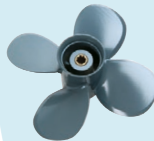
Ein Power-Thrust-Propeller (Schubpropeller) ist erhältlich, so dass diese Motoren auch für den Einsatz an schwereren Booten geeignet sind.
