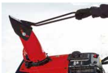
Manuell gesteuerter Auswurftrichter beim HS 750 EMA
