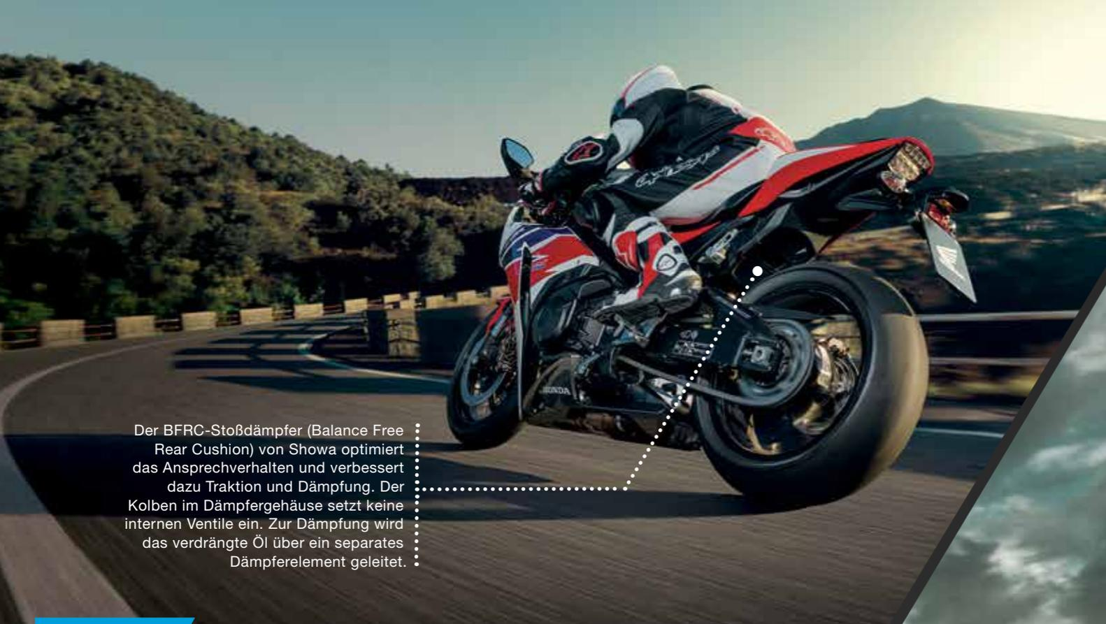
Der BFRC-Stoßdämpfer (Balance Free Rear Cushion) von Showa optimiert das Ansprechverhalten und verbessert dazu Traktion und Dämpfung. Der Kolben im Dämpfergehäuse setzt keine internen Ventile ein. Zur Dämpfung wird das verdrängte Öl über ein separates Dämpferelement geleitet.
