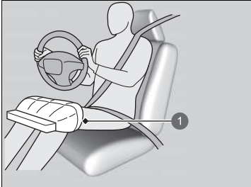
① Ausgelöster Fahrer-Knieairbag
