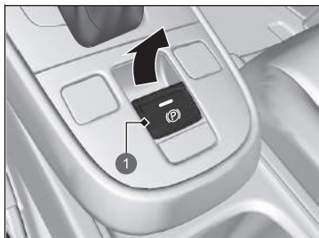
1 Schalter für die elektrische Feststellbremse
