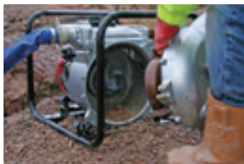
Der abnehmbare Inspektionsdeckel ermöglicht einen leichten Zugang
