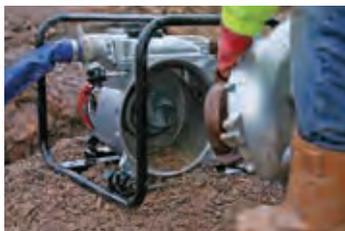
Der abnehmbare Inspektionsdeckel ermöglicht einen leichten Zugang
