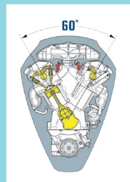
Der schmale Motorblock mit nur 60° vereinfacht die Installation, insbesondere bei einer Doppel- oder Mehrmotorisierung.
