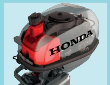
Die BF-Motoren sind speziell für die Aufnahme eines integrierten Kraftstofftanks (1,5 l) konzipiert.
