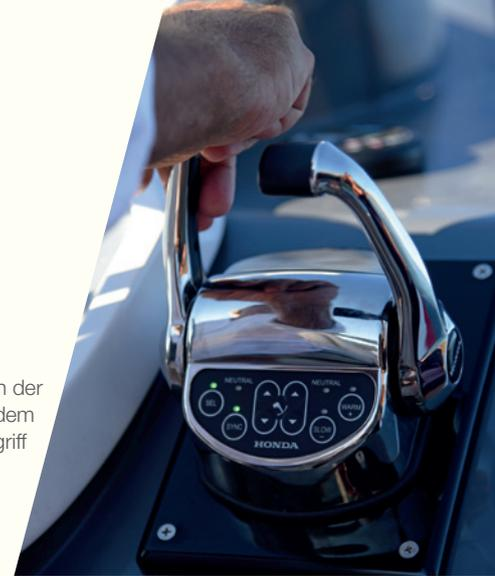
Präzises Einstellen der Motorendrehzahl mit dem handlichen Steuergriff
