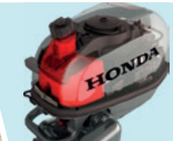
Die BF-Motoren sind speziell für die Aufnahme eines integrierten Kraftstofftanks (1,5 l) konzipiert.
