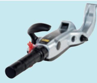
Die, als optionales Zubehör verfügbare, Multifunktionspinne für BFP60/BF60 enthält alle nötigen Funktionen: Trimm- und Tiltschalter, Trolling Schalter, Schalthebel, GriffhöhenEinstellung und Motorwarnanzeige.
