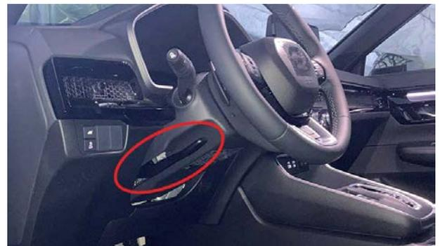
**Öffnen der Heckklappe von innen**
