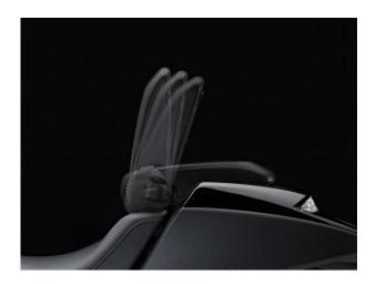
Eine ebenso clevere Idee stellt der Soziussitz dar, der als Rücklehne aufgeklappt zusätzlichen Komfort für den Fahrer oder die Fahrerin bietet. Die Lehne lässt sich aufgeklappt in drei verschiedenen Winkeln arretieren sowie 25 mm nach vorne oder hinten schieben, um für alle Körpergrößen eine optimale Position einstellen zu können.
