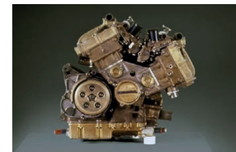
Der erste Honda V4-Motor, der 1978 für die Motorradweltmeisterschaft entwickelt wurde
